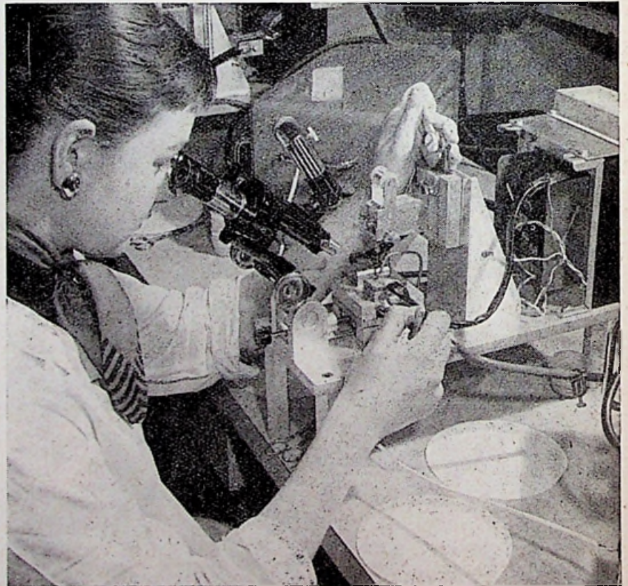
Halfgeleider-elementen, zoals transistordiodes, fotoelementen, gestuurde gelijkrichters, worden in de electronica steeds meer toegepast. Op deze foto het lassen van verbindingen aan een halfgeleider-diode.
